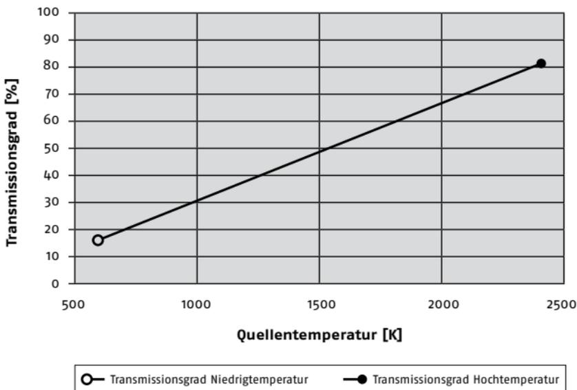
Wie aus diesem Bild ersichtlich, ist der von diesem Visier gebotene Schutz gegen Strahlungswärme von der Temperatur der Wärmequelle abhängig. Je höher die Temperatur ist, umso höher ist die schädigende Wärme, die auf das Auge trifft. Das Visier sollte nur in Situationen eingesetzt werden, in denen es die Exposition des Auge des Trägers auf weniger als  $100 \text{ W/m}^2$  reduzieren kann.
