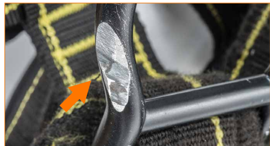
Anschlagung mit offensichtlichem Anzeichen von Abrieb.
