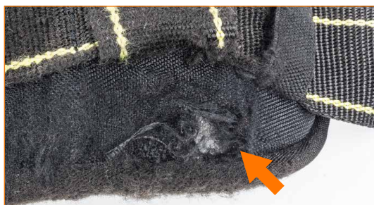
Rembourrage très usé. L'usure des parties non structurelles ne doit pas être sous-estimée parce qu'elle peut être un indicateur général de l'état d'usure de l'EPI.
