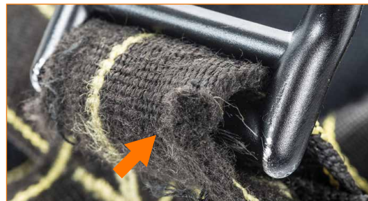
Fettuccia estremamente usurata in prossimità dell'anello ventrale.
