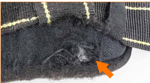
Stark abgenutzte Polsterung. Die Abnutzung nicht struktureller Teile darf nicht unterschätzt werden, da es ein allgemeines Anzeichen für den Gesamtverschleiß des Produktes sein kann.
