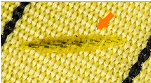
Sangle présentant des traces de brûlure dues au contact avec un corps brûlant.
