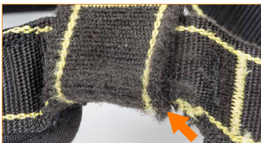
Riemen mit extremer Abnutzung in der Nähe der Überkreuzungen des Riemens.
