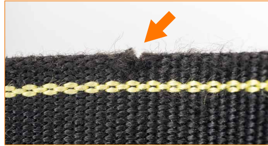
Riemen mit leichtem Einschnitt außen.
