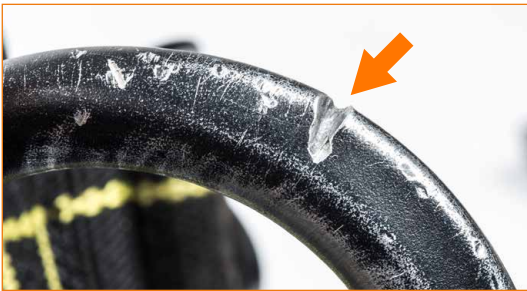
Anschlagung mit Einschnittstelle.
