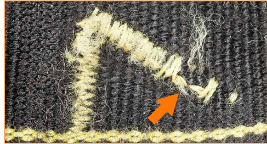
Sicherheitsnaht mit durchtrennten Fäden.
