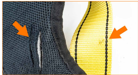
Beschädigte Polsterung. Achtung! Aufmerksam eventuelle strukturelle Riemen unter und auf der Polsterung überprüfen. Man bemerke den (leichten) Schnitt rechts auf dem Riemen.
