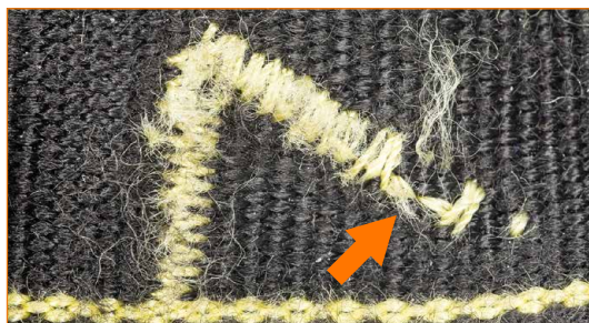
Costuras de seguridad con hilos cortados.
