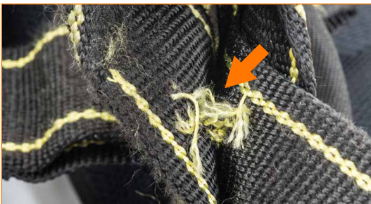
Sicherheitsnaht mit beginnendem Aufriss.
