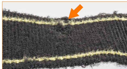
Cinta desgastada con evidente salida de hilachas.
