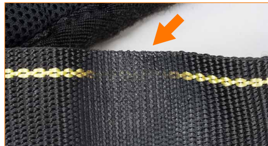
Riemen mit Brandstelle durch Nähe zu Wärmequelle.
