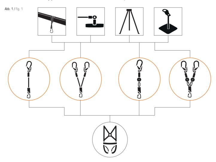
**DE** Für den Auffanggurt ist nur entscheidend, dass die eingeleitete Kraft bei jedem Gewicht unter 6 kN reduziert wird. Bei einer Prüfung mit mehr als 100 kg im gleichen Prüfaufbau nach EN 361 wird eine höhere Kraft in die Sicherungskette eingeleitet (siehe Abb. 1 Standard Prüfungen mit 100 kg ca. 12 kN, ca. 14 kN bei 140 kg Prüfgewicht).
